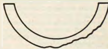
9. ábra A kóboráram-korrózió sematikus ábrázolása
