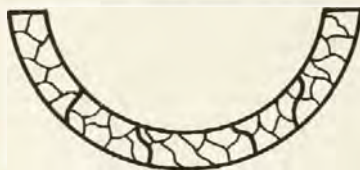
7. ábra Kristályközi korrózió sematikus ábrázolása
