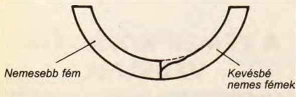
8. ábra A kontaktkorrózió sematikus ábrázolása
