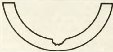
2. ábra Berágódási korrózió sematikus ábrázolása
